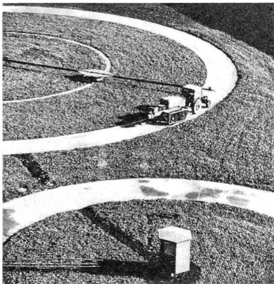
Les tracteurs sont notamment mis à l'épreuve sur des pistes circulaires en béton, où ils doivent tourner jour et nuit pendant 1000 heures, à l'extrémité d'une sorte de longe en acier. Ils sont commandés électroniquement et marchent sans conducteur. Des appareillages de mesure se trouvent sur la remorque.
