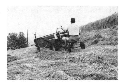
conserver à la machine son horizontalité transversale plus ou moins rigoureuse par l'abaissement de la roue de raie ou le relèvement de la roue de guéret. Quand il s'agit de faucher, d'autre part, il est possible, premièrement d'abaisser le centre de gravité, secondement de déplacer ce centre en direction de l'avant afin de rendre la conduite de la machine plus facile.
