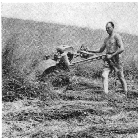
L'avance de la barre de coupe de ce tracteur à 2 roues (nécessaire pour compenser la résistance opposée par le fourrage à son avancement) est réglable entre 2 et 8°.
