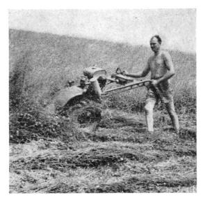
L'avance de la barre de coupe de ce tracteur à 2 roues (nécessaire pour compenser la résistance opposée par le fourrage à son avancement) est réglable entre 2 et 8º.
