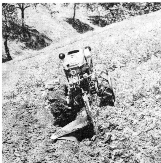
Aspect du tracteur à 2 roues dont les bras de l'essieu en portique peuvent pivoter indépendamment l'un de l'autre dans le sens vertical pour modifier la position des roues.
