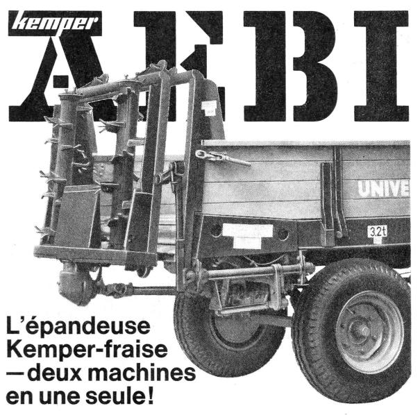
Posséder une épandeuse KEMPER-FRAISE, c'est posséder en une seule machine un modèle étroit et un modèle large. Le premier pour les champs (fumure intense), le second pour les prairies (fumure légère). Seule la KEMPER-FRAISE, dont la largeur d'épandage est réglable de 2,5 à 8 m, offre cet emploi double. Elle permet en plus de choisir la largeur de travail de telle manière qu'un chargement corresponde à la longueur d'un champ.
