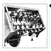
KEMPER fabrique également une épandeuse à 2 rouleaux horizontaux: la KEMPER-STANDARD. La largeur de travail couvre la voie de la machine et les couteaux sont interchangeables comme pour le modèle FRAISE.
