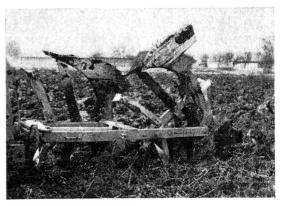
Fig. 13 Le système de protection contre les ruptures peut être fixé sur le cadre d'attelage et 14: de la charrue ou l'étançon de chaque corps. Son entrée en action provoque le relèvement de l'arrière de la charrue ou seulement de celui du ou des corps qui travaillent.
