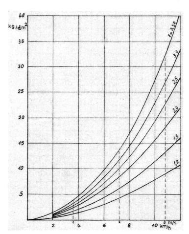
Fig. 7: Résistance dynamique de la charrue en kg/dm² ( gv²) de la formule 1 en fonction de la forme du versoir (g) et de la vitesse de déplacement (v).
