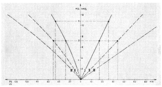
Fig. 9: La superficie labourée à l'heure ne s'accroît pas de façon proportionnelle à l'augmentation de la puissance nécessaire pour la traction de la charrue. Aussi est-il plus indiqué d'utiliser par exemple une charrue bisoc au lieu de rouler plus vite avec une charrue monosoc.
