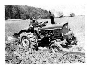
Tracteur John Deere «1020» (47 ch) — Ce matériel comprend notamment une boîte de vitesses à 8 marches avant et 4 marches arrière, un moteur Diesel 4-temps à 3 cylindres refroidi par eau et à injection directe, un système de régulation hydraulique automatique combinée de la profondeur de travail. Le «1020» est également livré en tant que tracteur pour cultures fruitières et tracteur à voie étroite pour les vignes.
