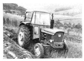
Tracteur John Deere «920» (40 ch) — Il comporte entre autres les équipements suivants: boîte de vitesses à 8 marches avant et 4 marches arrière, système de régulation hydraulique automatique combinée de la profondeur de travail indépendant de l'embrayage, moteur Diesel 4-temps à 3 cylindres refroidi par eau et à injection directe.
