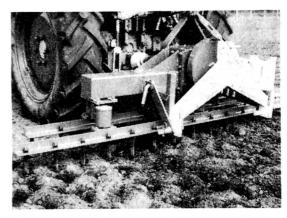
Vue de la herse portée à va-et-vient «Amazone» (à mouvements alternatifs rectilignes) entraînée par la prise de force au moyen d'une boîte à engrenages.
