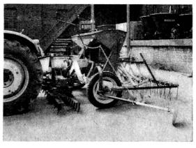
Combinaison de trois matériels (herse à va-et-vient «Amazone» + semoir + herse à semis portée par le semoir) grâce à laquelle il est possible d'ensemencer un champ directement après le passage de la charrue.
