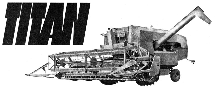
Coupes: 5,40 m - 4,50 m - 3,60 m - 3 m. Moteur: 6 cyl./125 CV Avancement: hydrostatique. Rendement: jusqu'à 3 ha/heure.
