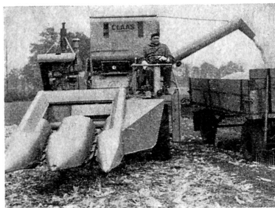
Moissonneuse-batteuse automotrice Claas «Mercure» pourvue d'un équipement à maïs-grain à 2 rangs seulement destiné à cueillir les épis. Les tiges ne sont pas coupées et la séparation des épis a lieu par arrachement.
