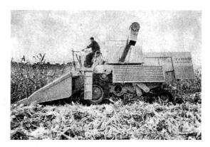
Moissonneuse-batteuse automotrice Claas «Consul» munie d'un équipement à maïsgrain prévu pour le fauchage-battage de cette céréale. Les tiges sont tranchées à la base par la barre de coupe de la machine.
