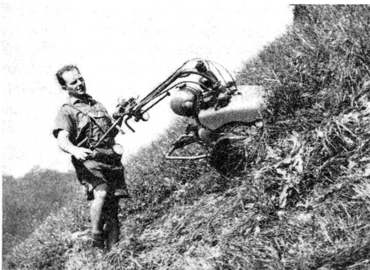
Fig. 2: L'autre motofaucheuse suisse, équipée de roues d'adhérence à crampons, mise à l'épreuve par un collaborateur du même institut sur un champ de très forte déclivité.
