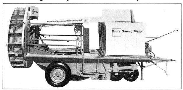
La récolteuse Samro-Major est livrable avec un dispositif ensacheur ou avec un chargeur en vrac ou avec une trémis basculante à commande hydraulique d'une contenance de plus de 1100 kg. Ses trois équipements sont interchangeables.
