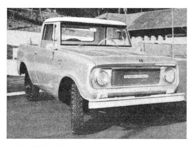
Aspect du nouveau véhicule polyvalent International Scout 800 réalisé par l'IHC. Il comporte quatre roues motrices, une cabine chauffable et démontable tout acier avec trois places assises, ainsi qu'un grand plateau de chargement et un panneau arrière rabattable. Sa charge utile est de 790 kg.
