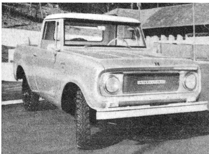
Aspect du nouveau véhicule polyvalent International Scout 800 réalisé par l'IHC. Il comporte quatre roues motrices, une cabine chauffable et démontable tout acier avec trois places assises, ainsi qu'un grand plateau de chargement et un panneau arrière rabattable. Sa charge utile est de 790 kg.
