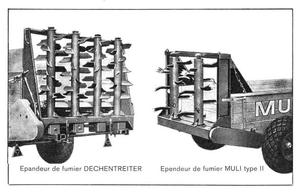
Pour les exploitations petites ou moyennes le MULI est un épandeur excellent. Il peut être équipé selon désir avec un hérisson horizontal ou deux hérissons verticaux. Il est facile à tirer et malgré son prix bon marché d'une construction très robuste. Sa surface de chargement extrêmement basse facilite énormément le chargement. Le MULI a toujours fait ses preuves même dans les régions montagneuses.
