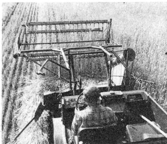
Fig. 2: Système moderne de récolte des céréales avec une faucheuse-andaineuse. Ce matériel, dont l'entraînement a lieu par la prise de force avant, comprend pour l'essentiel une longue barre de coupe frontale, un moulinet rabatteur, un ruban transporteur transversal et deux diviseurs de récolte. Le conducteur de la machine de traction jouit d'une bonne visibilité sur la faucheuse-andaineuse et peut manœuvrer commodément celle-ci (terrage et déterrage exécutés grâce au vérin hydraulique frontal) sans qu'il lui faille quitter son siège. Le blé coupé est laissé en andains sur des éteules de 20 à 25 cm. Il se trouve ainsi isolé du sol et l'aération de la récolte par en dessous active le séchage.
