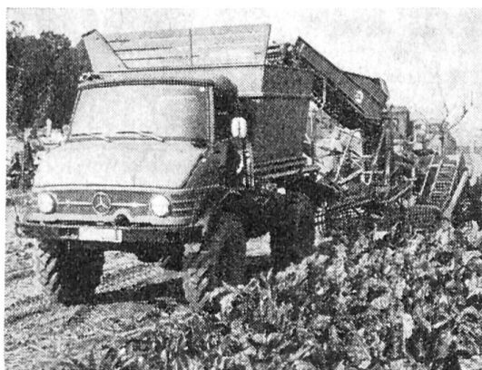
Fig. 3: Trémie de réception basculante de récolteuse de betteraves montée sur le plateau de charge de l'Unimog. Elle peut contenir 2500 kg de betteraves à sucre. Cela suffit pour n'importe quelle longueur de champ, parfois même pour deux passages, de sorte qu'il est possible de déverser les betteraves sur une seule fourrière. Durant le ramassage, l'accumulation du produit dans la trémie a pour effet d'alourdir toujours davantage les deux essieux moteurs. L'adhérence du véhicule s'en trouve ainsi encore améliorée. Le travail se déroule sans ennui même par mauvais temps, cela d'autant plus que le conducteur est bien abrité. Il peut manœuvrer à l'aide de la force hydraulique et surveiller la décolleteuse-arracheuse-chargeuse avec la plus grande commodité.
