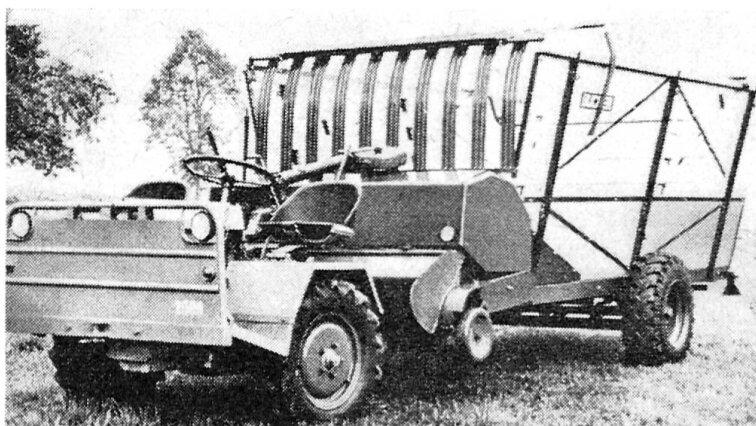
Fig. 2: Combinaison d'un avant- train à moteur de char automoteur avec une remorque autochargeuse. Un point qui frappe est le centre de gravité très bas de l'ensemble de ce véhicule.
