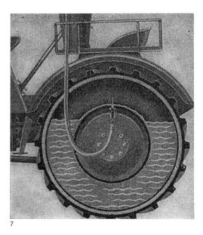
Fig. 7: On peut utiliser un récipient rempli d'eau, placé à bonne hauteur, si l'on ne dispose pas d'une canalisation d'eau sous pression.
