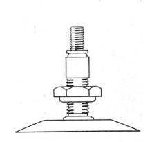
Fig. 2: Valve spéciale pour gonflage à l'air et à l'eau.
