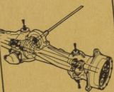
Nouvel arbre de transmission pour le type à 4 roues motrices, sans joints de cardan
