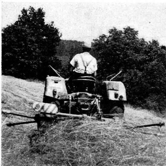
La nouvelle petite faneuse «Bautz» à toupies de type tracté qui se fixe à la barre d'attelage.
