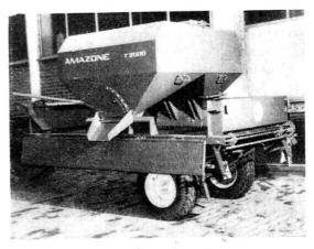
Le nouveau récipient métallique «Amazone» à double trémie et double goulotte de décharge pour le transport de divers produits en vrac (grain, engrais en granulés ou en cristaux, etc.).
