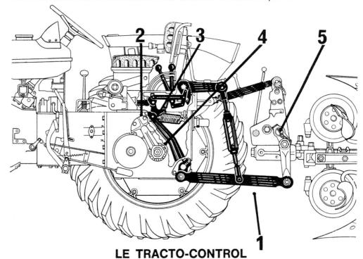
La régulation automatique de profondeur à transfert de charge permanent est obtenue par les bielles de traction (1) qui transmettent directement au distributeur (2) par les leviers (3) et (4) les différents efforts enregistrés par les outils (5) en fonction de la qualité du terrain, de son profil et de la position du tracteur.
