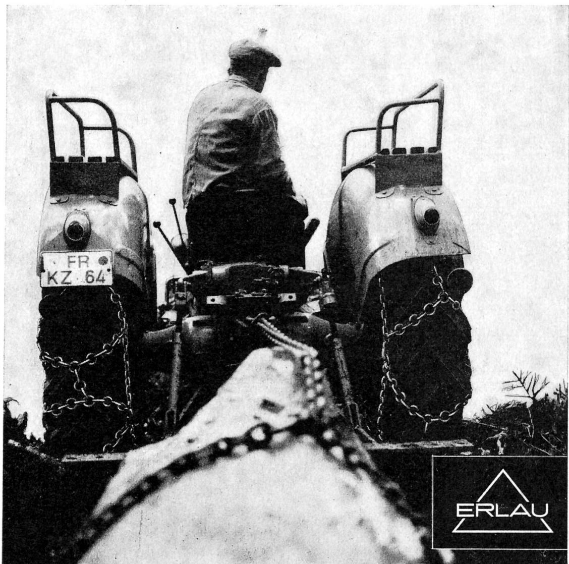
Lorsque le terrain est glissant, gras ou boueux, seul un bon mordant permet aux roues d'utiliser toute la puissance du moteur. Les chaînes **ERLAU-EUROPA** pour tracteurs donnent un tel mordant. Leur élément d'attaque est unique, c'est une échelle massive en acier spécial. Cela mord profondément dans le sol, comme de puissantes griffes. Il en résulte une tenue exacte de la voie à suivre, une haute capacité de départ et de freinage, ainsi qu'un nettoyage rapide s'effectuant de lui-même.
