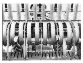
L'autochargeuse tractée Hamster Minor est pourvue d'un dispositif de coupe (équipement de série) dont les couteaux peuvent être mis en place ou enlevés rapidement et sans outil. Cet organe a été conçu de façon à pouvoir être employé à volonté avec de 1 à 5 couteaux. De plus, ces couteaux sont réversibles (les deux extrémités comportent un tranchant), de sorte que leur durée d'utilisabilité se trouve doublée.
