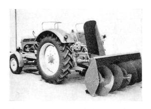
Ce matériel, livrable en deux modèles de grandeur différente, est spécialement prévu pour être monté à l'arrière des tracteurs agricoles. Il s'agit du type SS 185/60, d'une grande capacité de travail et de prix avantageux. Il convient pour tous les tracteurs d'une puissance minimale de 34 ch et qui sont équipés d'un relevage
