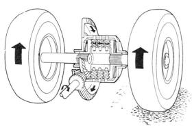
Aspect du différentiel de type nouveau dont sont équipées des machines de chantier Caterpillar. Les flèches indiquent comment les roues dentées de ce mécanisme fonctionnent quand une des roues motrices de la machine commence à patiner.
