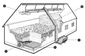
Dessin montrant la disposition du répartiteur de foin Allgäu, entièrement automatique, dans la grange: 1 = Remorque autochargeuse, 2 = Elévateur mécanique à ruban, 3 = Répartiteur de foin Allgäu, 4 = Plancher à claire-voie, 5 = Aérateur de grange (ventilateur + moteur) Allgäu.
