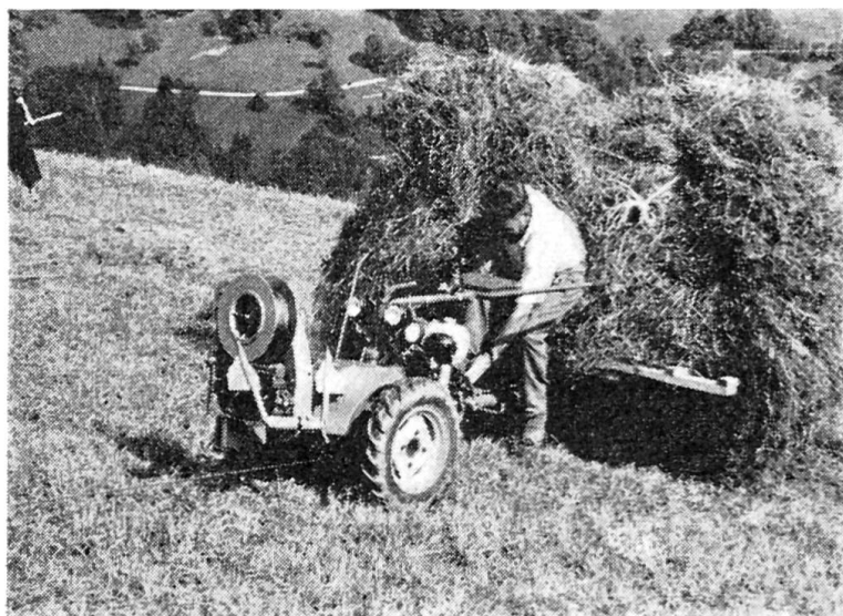
Fig. 3: Application de la méthode de l'autohalage avec une motofaucheuse légère dite de montagne. Le cabestan spécial est monté sur cette dernière. On distingue la grande bobine d'enroulement.
