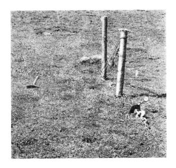
En se reportant tout d'abord au tableau 1, on voit par exemple que la traction exercée sur l'ancrage (sur une pente de 60 % d'inclinaison et avec un effort de traction fourni à la fois par le câble et les roues) représente 390 kg. En examinant ensuite le tableau 2, on constate alors que sur un sol relativement ferme, la force tractive nécessaire pour arracher un ancrage
