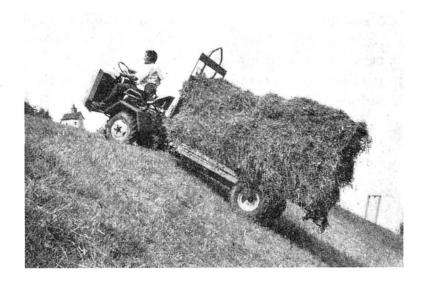
procédé concernant le réglage correct de la vitesse d'avancement supérieure du véhicule par rapport à la vitesse d'enroulement du câble (cette vitesse supérieure a pour but de compenser le glissement des roues), la répartition de l'effort de traction entre les roues et le câble, le comportement des dispositifs d'ancrage artificiels lors de conditions de sol différentes, etc., ont donné les résultats suivants:
