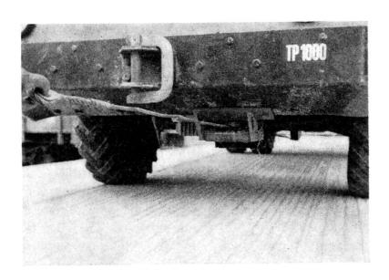
Enroulement du câble: Il doit s'effectuer de manière automatique et avoir lieu de telle façon qu'un endommagement du câble provoqué par un enroulement incorrect se trouve exclu.
