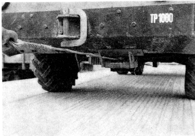
Fig. 7: Une poulie de guidage, montée sur le châssis du char automoteur, est destinée à empêcher que le câble tracteur, l'essieu ou des parties du moteur soient éventuellement endommagés.
