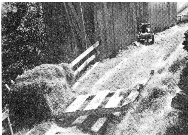
Fig. 5: Schlitte à foin d'une grande capacité de réception pouvant être utilisée lorsque les circonstances obligent à recourir à la traction par câble de type traditionnel.
