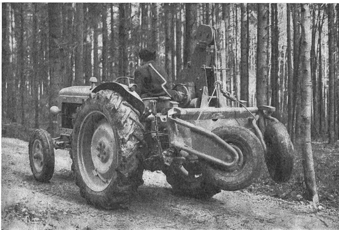
Fig. 1: Aspect du chariot débardeur «SR» (porté quand il n'est pas chargé) qui s'adapte au système d'attelage trois-points du relevage hydraulique de tout tracteur agricole de type courant.
