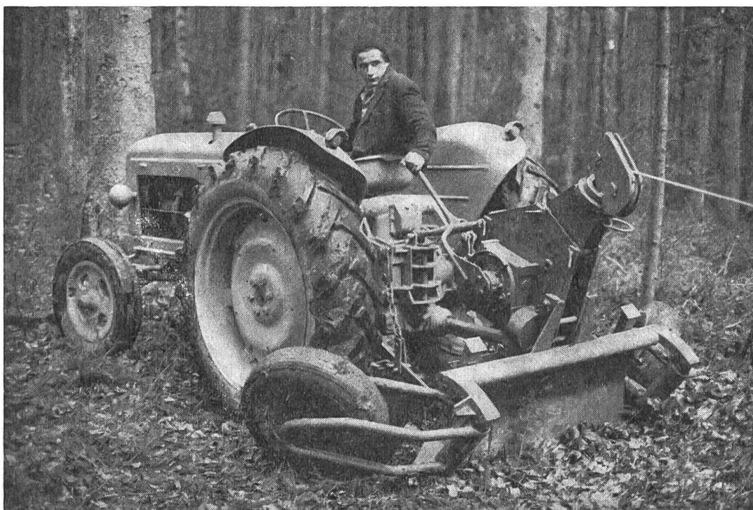
Fig. 2: Vue du même matériel en position basse extrême prêt à haler la bille au sol jusqu'au tracteur à l'aide du treuil dont il est équipé. Le câble de ce treuil a une force de traction maximale de 3 tonnes.
