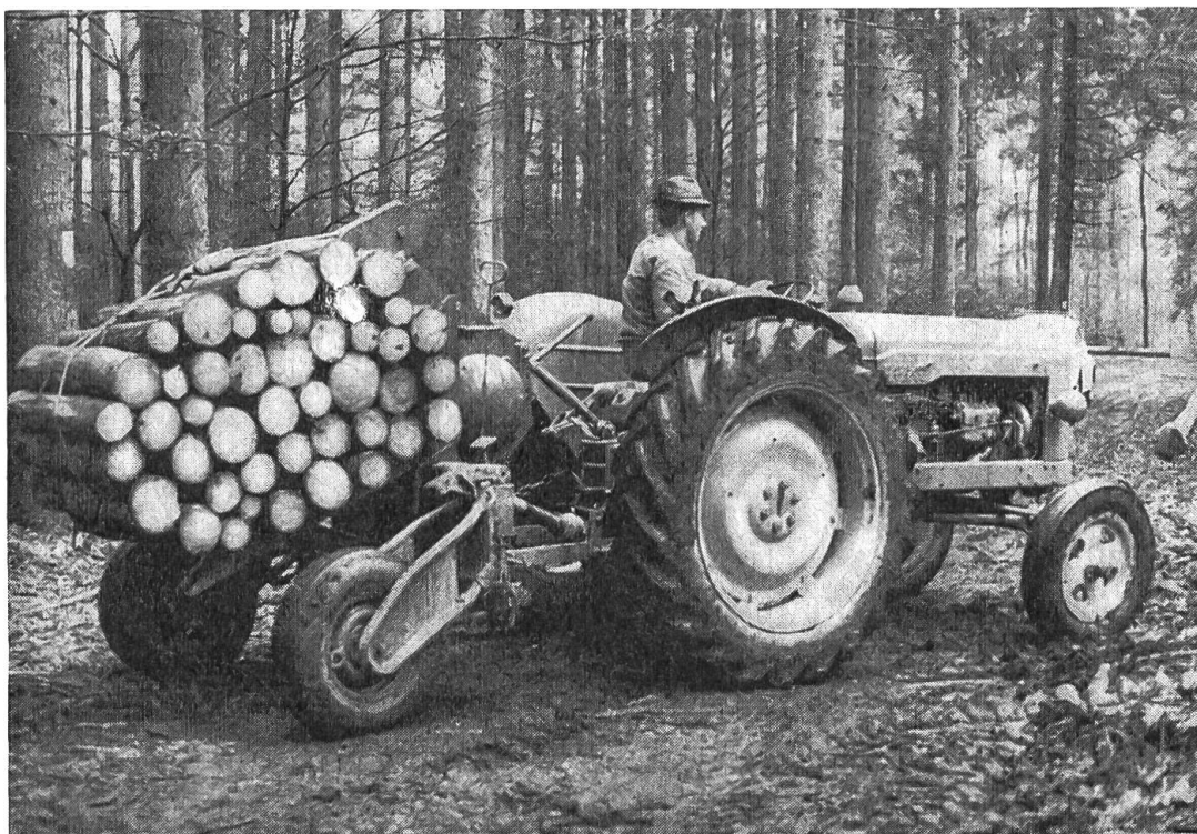
Fig. 6: Le chariot débardeur mis en ordre de route avec son chargement de rondins. Deux heures suffisent au conducteur du tracteur pour apprendre à se servir de ce matériel.
