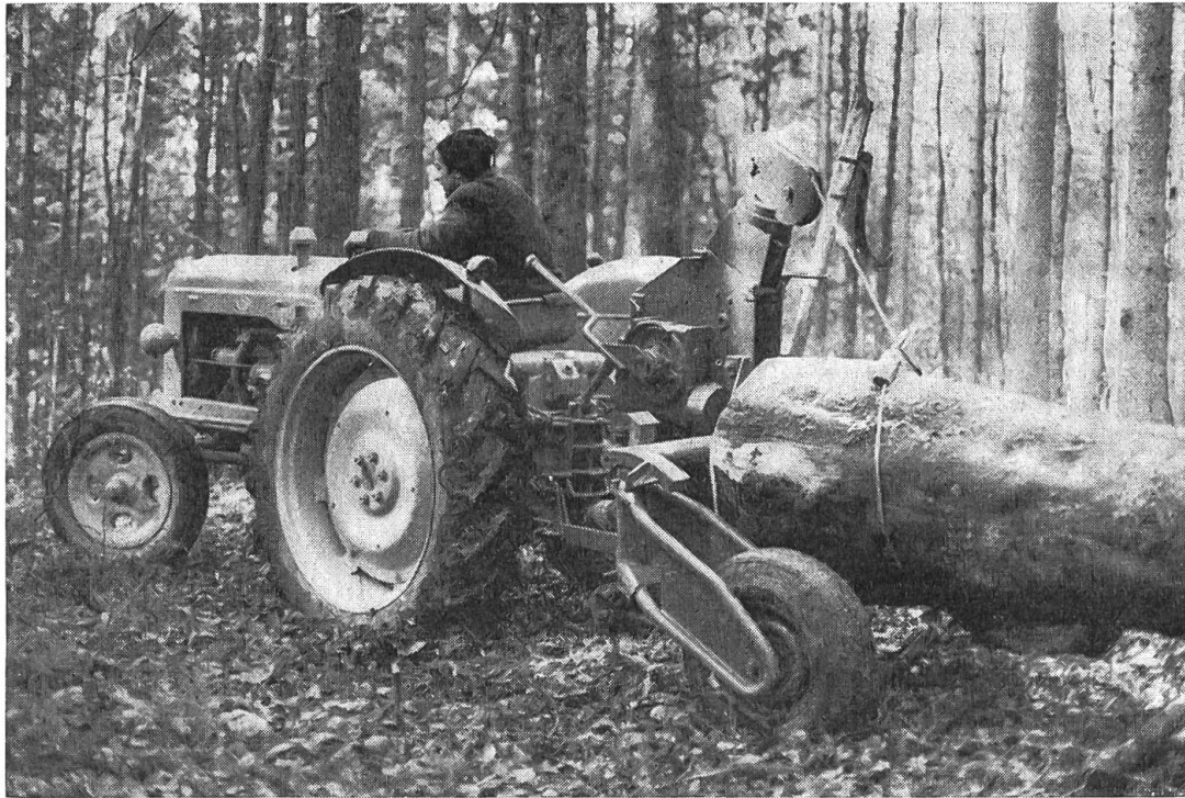
Fig. 3: Débardage à la traîne d'une bille de 3,8 m 3 . La force portante du chariot «SR» est de 2 tonnes, et son poids, treuil compris, de 540 kg. Quant à son prix, il s'élève à Fr. 6700.—.
