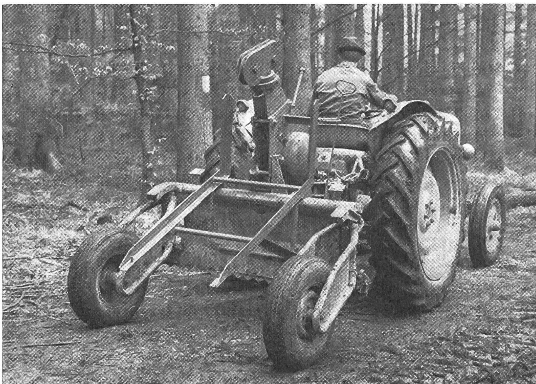
Fig. 4: Ce matériel de débardage est pourvu ici d'un châssis spécial pour lui permettre de transporter du bois enstéré. Son attelage au tracteur ou son dételage s'opère en quelques minutes.
