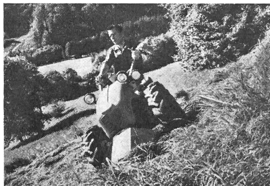
La motofaucheuse Rapid 505 (à mancherons pratiquement sans vibrations) vue en pleine action sur une prairie en pente.
