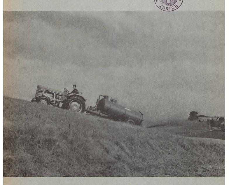
Le nouveau tracteur Hürlimann D 100 'S' remorquant une citerne à pression d'une capacité de 3000 litres et d'un poids à vide de 1000 kg soit au totale de 4000 kg, sur un terrain en pente de 42 %.
