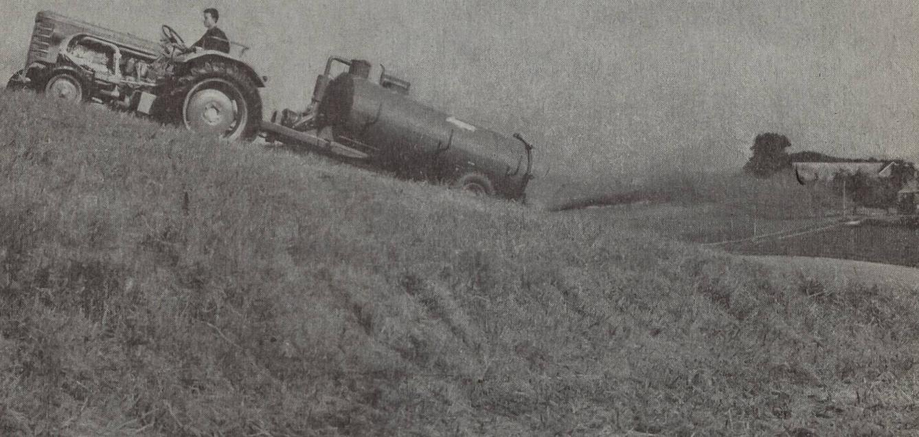
Le nouveau tracteur Hürlimann D 100 'S' remorquant une citerne à pression d'une capacité de 3000 litres et d'un poids à vide de 1000 kg soit au totale de 4000 kg, sur un terrain en pente de 42 %.
