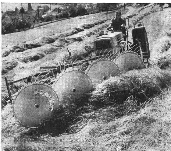
Fig. 7 et 8: Le principal avantage offert par un râteau andaineur à disques monté à l'avant (à gauche) est qu'il permet d'éviter que les roues du tracteur passent sur le fourrage, comme c'est le cas avec les exécutions prévues pour être attelées à l'arrière de la machine de traction (à droite). En revanche, un râteau andaineur à disques du type tracté se montre plus avantageux dès que l'on travaille sur un terrain en pente.
