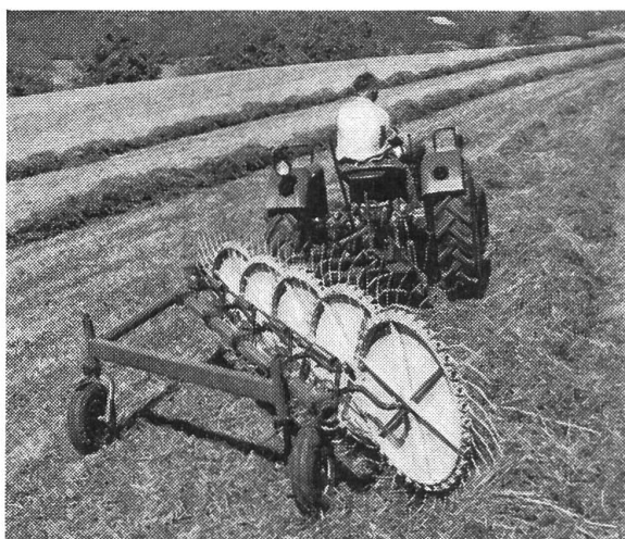
Fig. 7 et 8: Le principal avantage offert par un râteau andaineur à disques monté à l'avant (à gauche) est qu'il permet d'éviter que les roues du tracteur passent sur le fourrage, comme c'est le cas avec les exécutions prévues pour être attelées à l'arrière de la machine de traction (à droite). En revanche, un râteau andaineur à disques du type tracté se montre plus avantageux dès que l'on travaille sur un terrain en pente.
