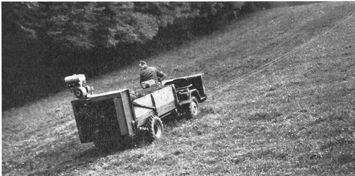
Fig. 1: Le nouveau char automoteur Aebi TP 1000 à traction par les 4 roues utilisé sur une prairie en pente avec une épandeur de fumier portée. — Le dispositif d'épandage (hérissans verticaux) est actionné par un moteur auxiliaire. Les chaînes transporteuses à cornières transversales sont entraînées par le moteur du char. Un treuil spécial permet au véhicule d'être aidé supplémentaires par son câble (autohalage).
