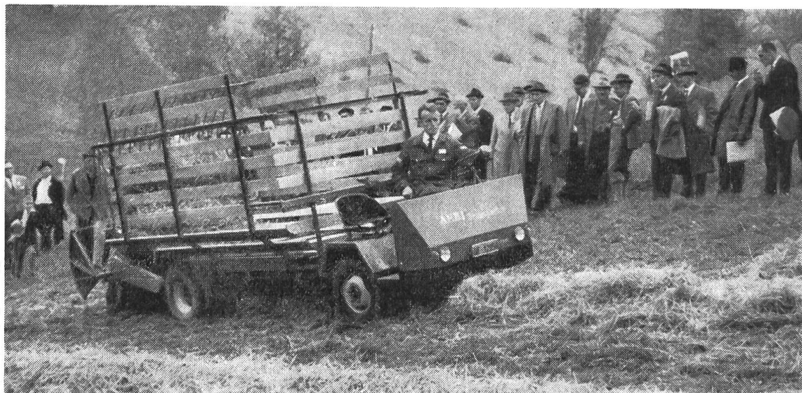
Fig. 2: Aspect du char automoteur tous-terrains employé avec une caisse de remorque autochargeuse pour la reprise du foin. — Les organes de ramassage-chargeement sont montés à l'arrière. La capacité de la cage à cadres à lattes est de 9 m 3 , ce qui correspond à 400–500 kg de fourrages secs. Le dispositif élévateur-chargeur n'exige pas une grande force d'entraînement.
