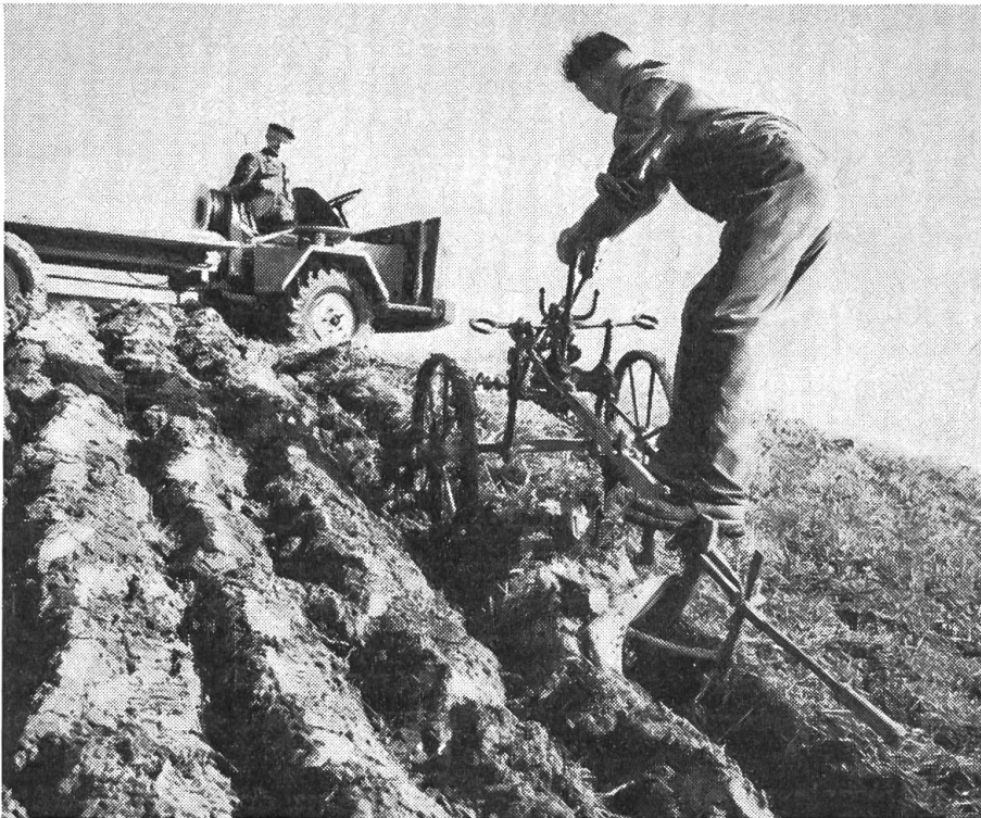
Fig. 3: Le nouveau char automoteur Aebi utilisé à poste fixe pour labourer au treuil (type cabestan). — Un dispositif d'ancrage se montre superflu, ce qui permet de gagner du temps.
