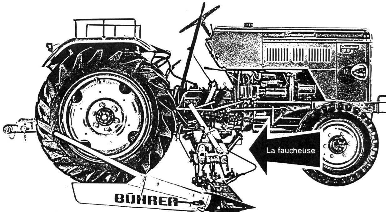
Sans aucun outil et en quelques secondes, la faucheuse au tracteur Bührer peut être montée et démontée. Grâce à la transmission TRACTOSPEED, elle peut être enclenchée et déclenchée ou changée d'une des deux vitesses à l'autre pendant la marche et sans débrayer. Ceci assure l'adaptation idéale à toutes les situations données et un fauchage expéditif et parfait.
