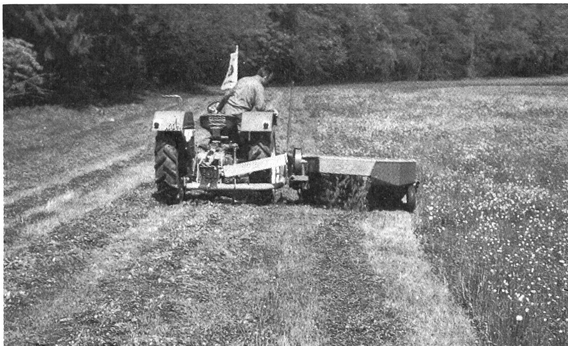
Fig. 3: Faucheuse portée à fléaux au travail. — L'herbe conditionnée (lacérée, écrasée) est disposée en un andain pour que les roues du tracteur ne la foulent pas au passage suivant.
