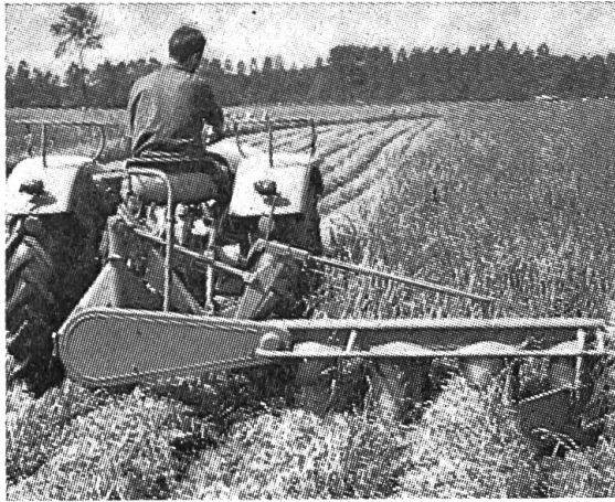
Fig. 6: Aspect d'une faucheuse portée à tambours rotatifs. — L'herbe coupée est groupée en deux andains aérés. Ce matériel absorbe une puissance d'entraînement élevée. En vue de pouvoir utiliser la faucheuse à tambours rotatifs également avec les tracteurs de type léger, la fabrique lancera prochainement sur le marché un modèle à largeur de travail réduite (1 m 10).
