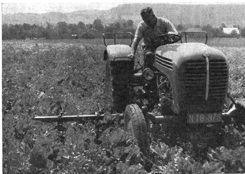
Fig. 1: Instrument de sarclage monté entre les essieux du tracteur. — Ce mode d'attelage exige une haute garde au sol et un empattement suffisant. S'il offre des avantages (bonne visibilité sur les outils, manœuvres plus faciles en fourrière, stabilité de l'ensemble), il présente aussi des inconvénients (démontage de la barre de coupe, montage compliqué, angle visuel trop grand, difficultés si présence de pièces de fixation pour le chargeur frontal).
