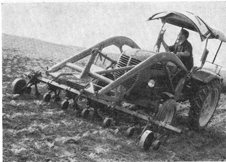
Fig. 5: Le conducteur jette un coup d'œil au clinomètre pour contrôler si l'inclinaison limite (du point de vue de la qualité du travail fourni) a été éventuellement dépassée sur ce champ en pente.
