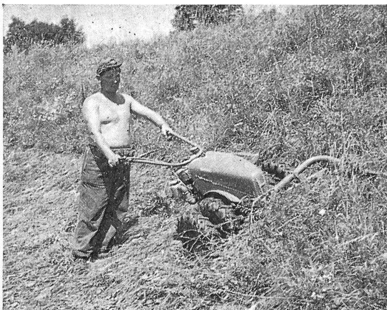
Fig. 5: La motofaucheuse que l'on voit ici constitue une réalisation de la fabrique allemande Holder. Cette machine est équipée d'une barre de coupe à double lame. Les doigts, les plaques de guidage et les plaques de débouillage ont été supprimés sur les barres de ce genre. Les avantages offerts par les barres de coupe à double lame sont les suivants:
