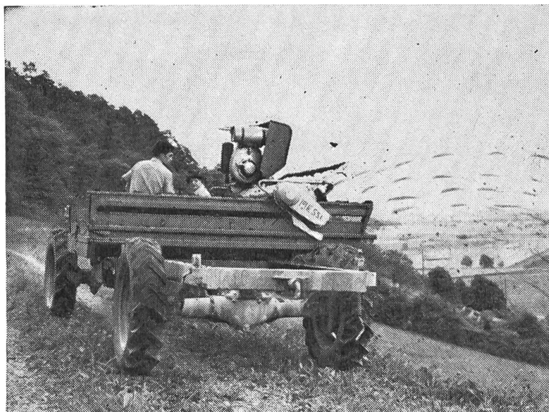
Fig. 4: Aspect d'une épandeuse de fumier amovible de forme carrée équipée d'un mécanisme distributeur mobile entraîné par moteur auxiliaire qui projette l'engrais sur le côté. Selon ce système, la masse de fumier ne se déplace pas.
