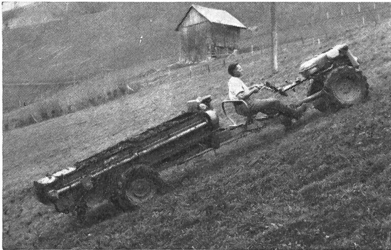
Fig. 7: Epandeuse de fumier à deux roues comportant un essieu moteur et des chaînes transporteuses à cornières transversales (raclant le plancher) qui a été attelée à un tracteur à deux roues. Dans un tel cas, il convient de donner la préférence à un modèle où l'entraînement du mécanisme distributeur est assuré par un moteur auxiliaire.
