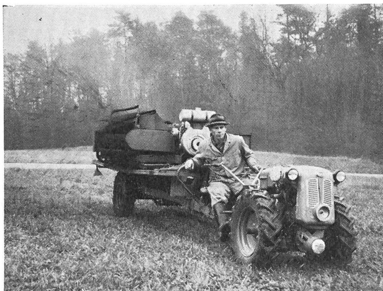
Fig. 5: Epandeuse carrée amovible à distribution latérale comportant un panneau mobile qui se déplace lentement en poussant la masse de fumier vers le hériss, lequel est également actionné par un moteur auxiliaire.
