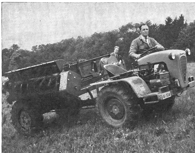
Fig. 6: Autre épandeuse de fumier amovible installée sur un char automoteur. Elle comporte aussi un hérisson horizontal disposé sur le côté (projection latérale de l'engrais) et un panneau mobile transporteur.
