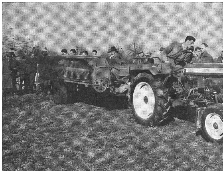
Fig. 8: Les épanduses de fumier amovibles à distribution latérale dont la caisse possède une grande capacité de réception peuvent être accouplées à des tracteurs d'une puissance minimale de 20 ch. La machine à distribution latérale que l'on voit ici comporte deux compartiments (cloison de séparation transversale). Au cours du travail, c'est le compartiment arrière qui se vide le premier. La vidange du compartiment avant débute automatiquement dès que celle de l'autre est terminée.
