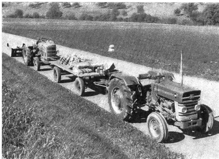
Fig. 3: Pour les mesurages qui doivent être effectués avec un glissement déterminé, le tracteur «freineur» (attelé en queue) a fait ses preuves, étant donné qu'il permet au conducteur de ce tracteur de doser très exactement le freinage. Le compteur de tours du moteur indique en outre si la vitesse d'avancement voulue est bien observée.
