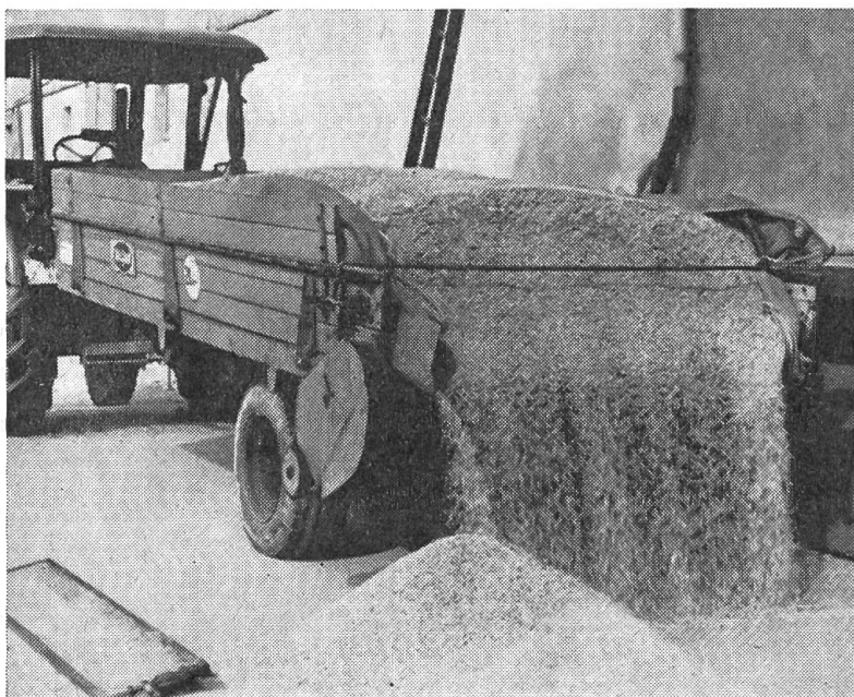
Fig. 2: Epandeur de fumier équipée pour le transport du grain. — Le mécanisme d'épandage a été remplacé par un hayon métallique qui fait office de glissoire de déversement lors du déchargement.
