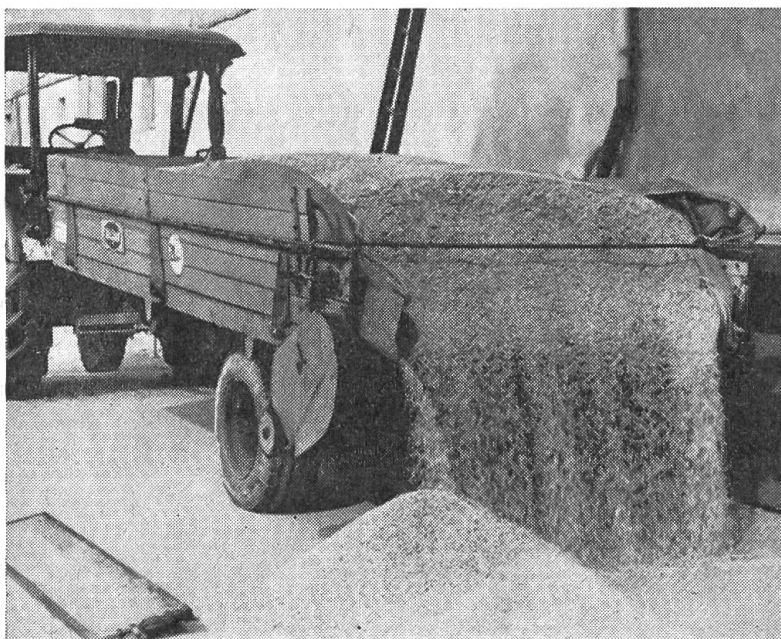
Fig. 2: Epandeur de fumier équipé pour le transport du grain. — Le mécanisme d'épandage a été remplacé par un hayon métallique qui fait office de glissoire de déversement lors du déchargement.
