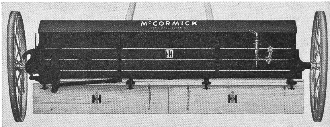
Fig. 5: Aspect d'un distributeur d'engrais à deux demi-grilles à va-et-vient et orifices d'épandage rectangulaires.
