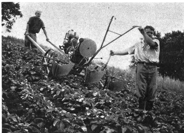
Fig. 2: Monté sur un instrument universel à trois rangs, prévu pour la traction animale, le mototreuil à système cabestan a fait ses preuves sur un champ de pommes de terre de semence d'assez forte inclinaison.
