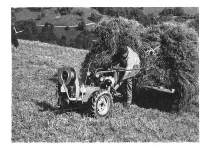
Fig. 6a: La même remorque chargée de foin (150 à 200 kg) en train de gravir une pente grâce au système de l'autohalage.
