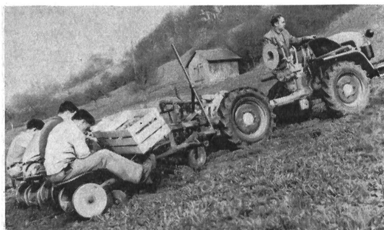
Fig. 3a: Aspect d'une machine de traction à quatre roues motrices possédant les aptitudes requises pour un emploi sur les terrains en pente et que l'on a équipée d'un treuil du type cabestan.
