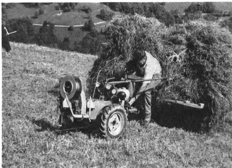
Fig. 6a: La même remorque chargée de foin (150 à 200 kg) en train de gravir une pente grâce au système de l'autohalage.
