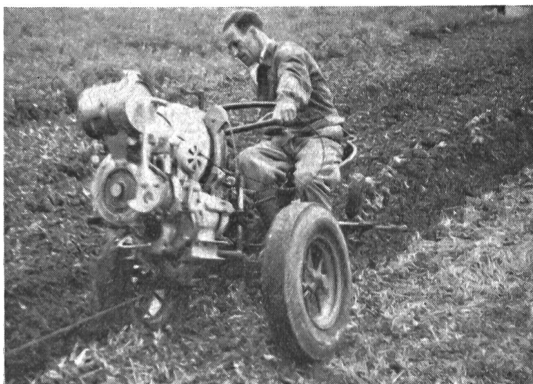
Fig. 1a: Travail effectué sur un terrain en pente selon le système de l'autohalage tel qu'il est décrit dans le Courrier de l'IMA 4-5/1958 (avant-train autohaleur avec siège et roues non motrices sur lequel a été monté un treuil spécial dit cabestan et un moteur d'entraînement).
