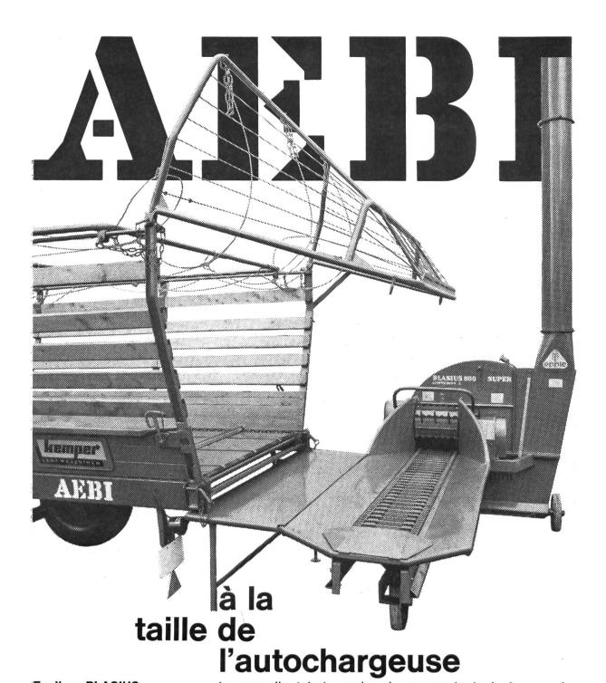
Ensileur BLASIUS 800 Super avec trémie prolongée et table de dosage La nouvelle trémie prolongée couvre toute la largeur de l'autochargeuse. La table de dosage est réglable en hauteur; elle se fixe à gauche ou à droite de la trémie. Ainsi, le fourrage qui tombe de l'autochargeuse peut être étalé sur la table et dirigé ensuite en quantités régulières sur la chaîne de transport.
