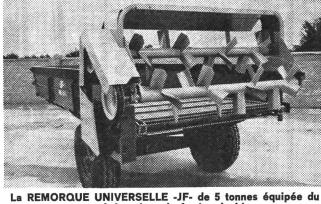
La REMORQUE UNIVERSELLE -JF- de 5 tonnes équipée du nouvel épandeur de fumier double.
