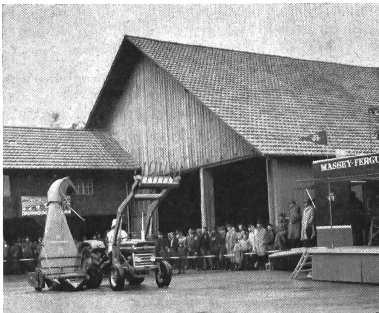
Fig. 3: Tracteur MF équipé d'un chargeur frontal et de la récolteuse de fourrages à fléaux MF, laquelle va faire ici l'objet de dé- monstrations.
