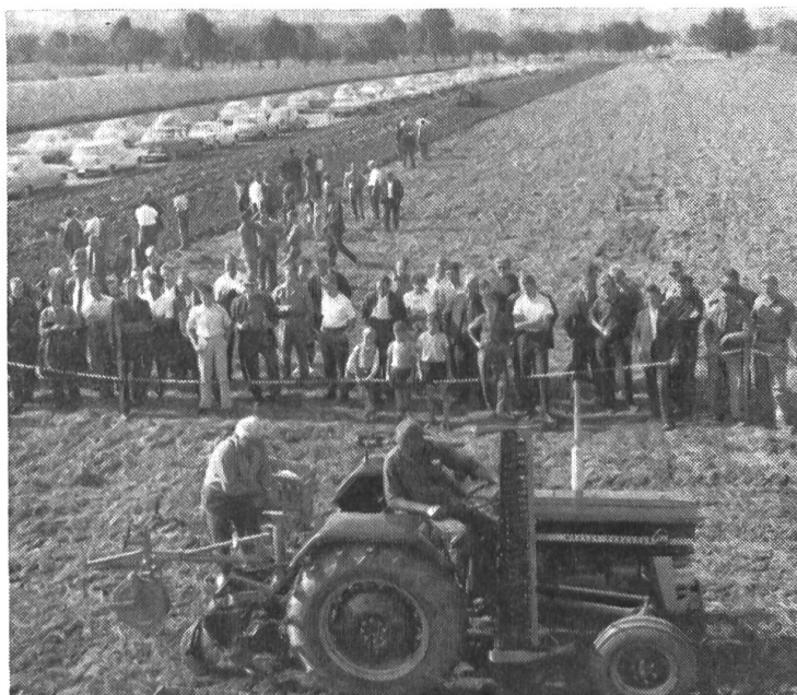
Fig. 5: Aspect de la planteuse de pommes de terre semi-automatique Rau- Combi. On peut l'obtenir en tant qu'exécution à 2 rangs ou à 4 rangs.
