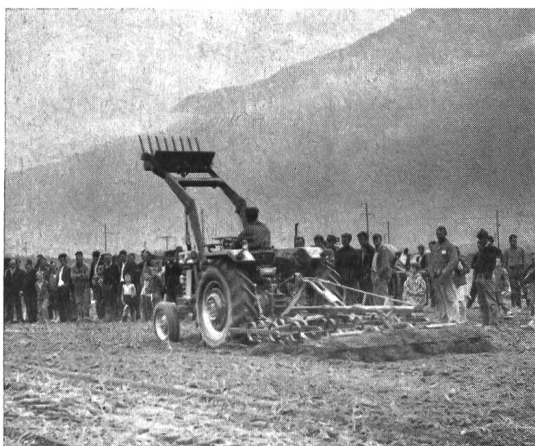
Fig. 6: Préparation du sol effectuée simultanément avec deux instruments Rau (vibroculteur et émotteuse).
