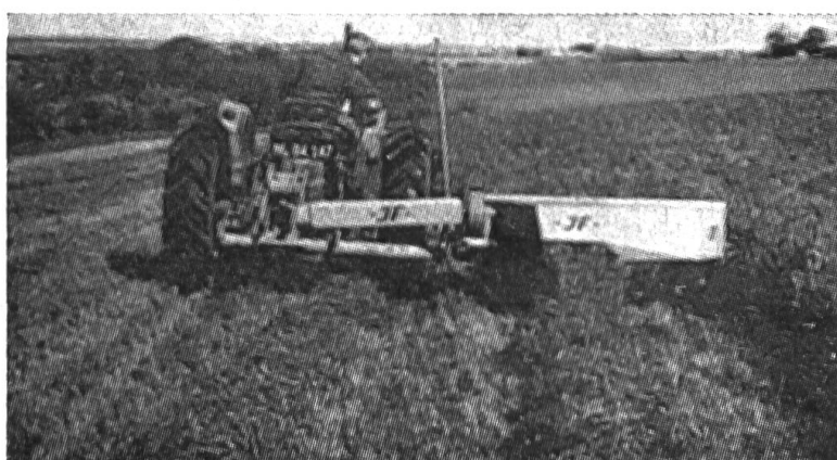
Fig. 22: La faucheuse portée à fléaux présente un intérêt certain. Elle travaille à côté du tracteur et le fourrage coupé se trouve disposé en un andain.
