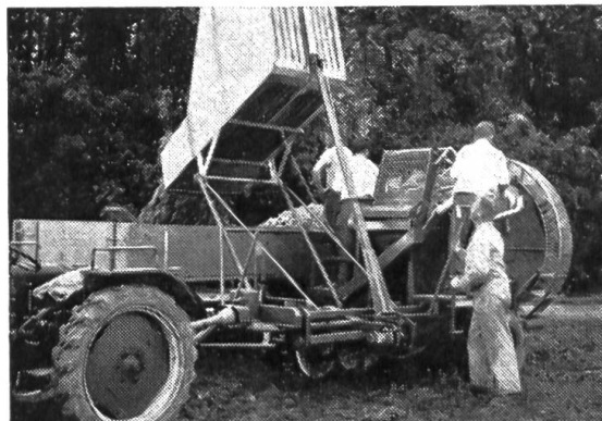
Fig. 15 et 16: Transbordement des sacs de pommes de terre et vidange de la trémie collectrice sur le véhicule de récolte. Comparativement à la manutention en sacs, la manutention des tubercules en vrac (trémie de réception) permet d'alléger le travail et d'économiser du temps. Cette méthode s'avère donc particulièrement avantageuse.
