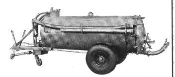
La nouvelle pompe M 3, d'un débit en liquide de 2000 l/min., avec son réservoir de 3 l. d'huile, muni d'une jauge graduée et son graissage automatique à l'aspiration et au refoulement, facilite l'utilisation en société.
