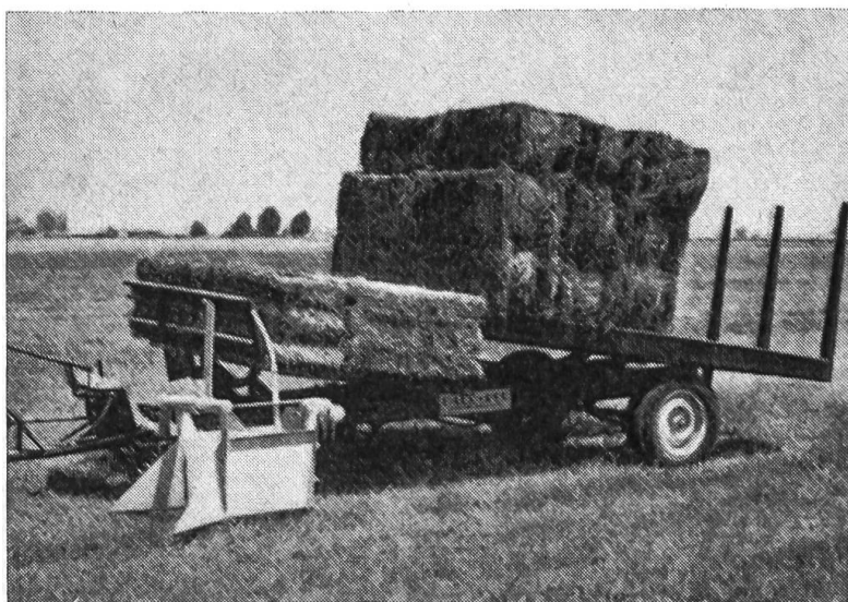
Fig. 16: Vue de la semi-remorque autochargeuse pour balles à haute densité qui ramasse, charge et décharge celles-ci de façon semi-automatique. Les différentes phases du travail exécuté par cette machine sont illustrées ci-contre.
