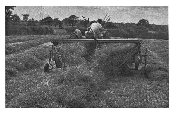
Fig. 13: L'épandeuse-faneuse «Lely» à tambour peut être utilisée non seulement pour épandre et faner, mais aussi pour mettre le fourrage en andains. Il suffit pour cela d'adapter deux ou quatre déflecteurs à barreaux à son capot suivant que l'on désire respectivement de gros ou de petits andains.
