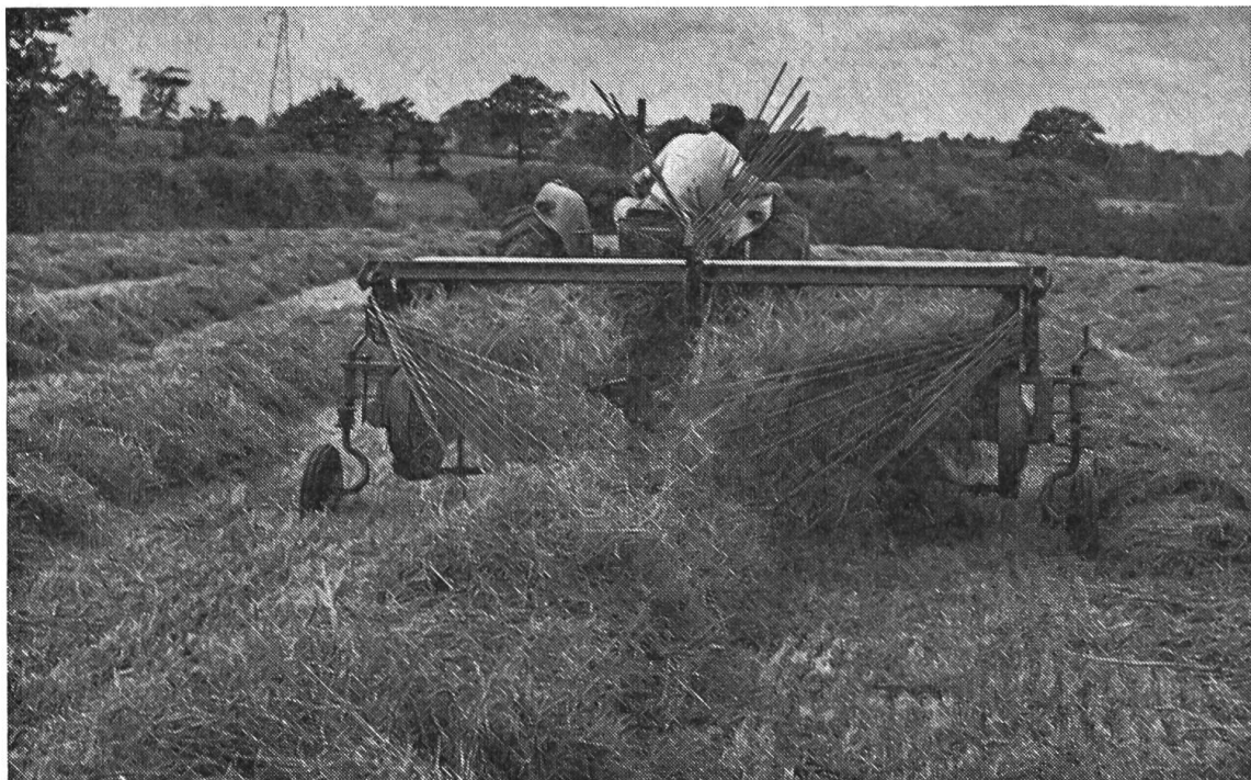
Fig. 13: L'épandeur-faneuse «Lely» à tambour peut être utilisée non seulement pour épandre et faner, mais aussi pour mettre le fourrage en andains. Il suffit pour cela d'adapter deux ou quatre déflecteurs à barreaux à son capot suivant que l'on désire respectivement de gros ou de petits andains.
