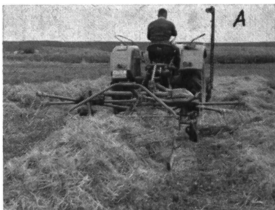
Fig. 11: Voici comment se présentent les faneuses à toupies «Bautz» (A) et «Lely» (B), qui comportent respectivement deux et quatre toupies et sont équipées d'un dispositif andaineur formant de gros andains au moment du râtelage.
