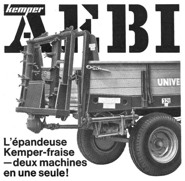
Posséder une épandeuse KEMPER-FRAISE, c'est posséder en une seule machine un modèle étroit et un modèle large. Le premier pour les champs (fumure intense), le second pour les prairies (fumure légère). Seule la KEMPER-FRAISE, dont la largeur d'épandage est réglable de 2,5 à 8 m, offre cet emploi double.
