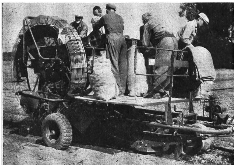
Fig. 3: Arracheuse-ramasseuse (récolteuse) à grille cribleuse fixe avec poste d'ensachage.
