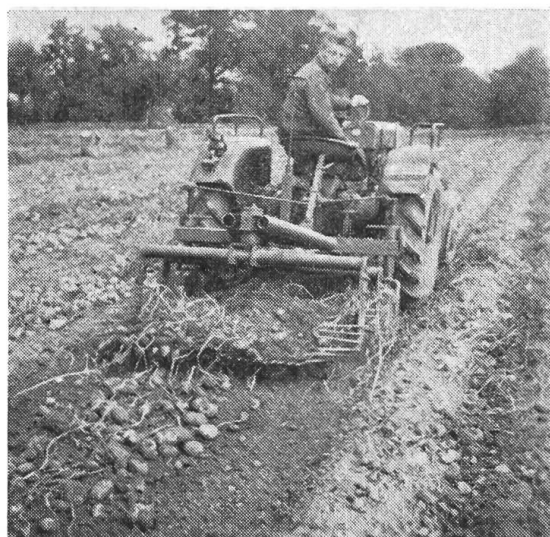
Fig. 1: Arracheuse-aligieuse à cribles oscillants travaillant simultanément deux rangées.
