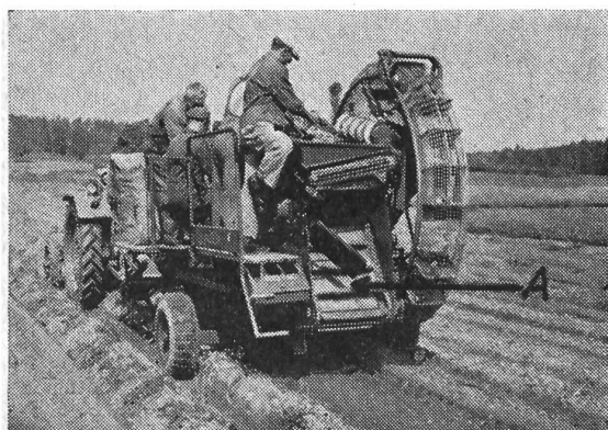
Fig. 7 et 8: L'évacuation des fanes de pommes de terre a lieu sur l'arracheuse-ramasseuse à grille cribleuse fixe (fig. 7) au moyen d'une chaîne transporteuse à cornières (A) et sur l'arracheuse-ramasseuse à chaîne cribleuse (fig. 8) par l'intermédiaire d'une chaîne à traverses largement espacées pourvue d'organes entraîneurs.
