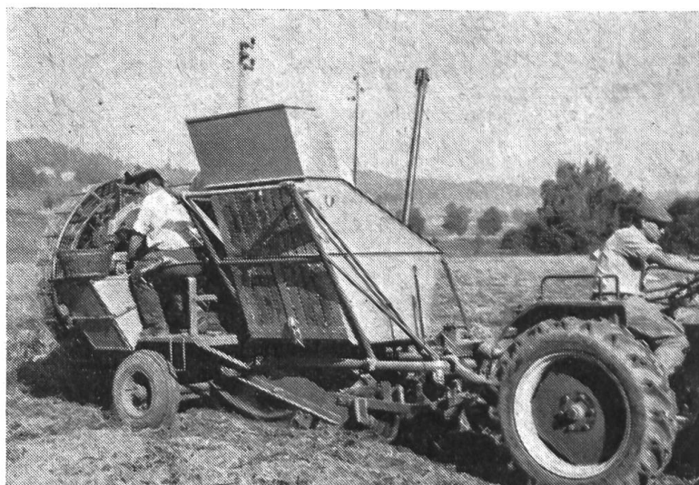
Fig. 4: Arracheuse-ramasseuse à chaîne cribleuse (récolteuse) équipée d'une trémie réceptrice basculable.
