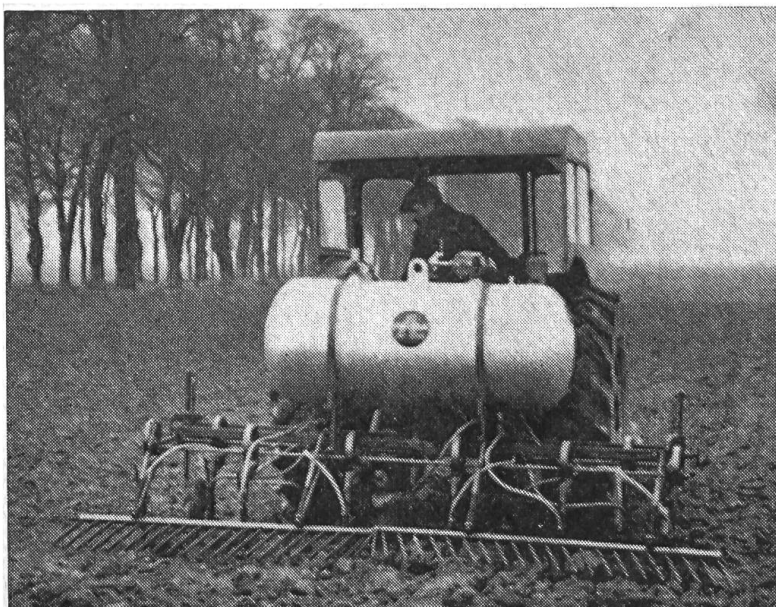
Fig. 7: L'épandage d'eau ammoniacale très diluée comme engrais azoté (nitrogation) se fait lors du passage de la charrue ou du cultivateur en utilisant un appareillage spécial que l'on adapte au tracteur.
