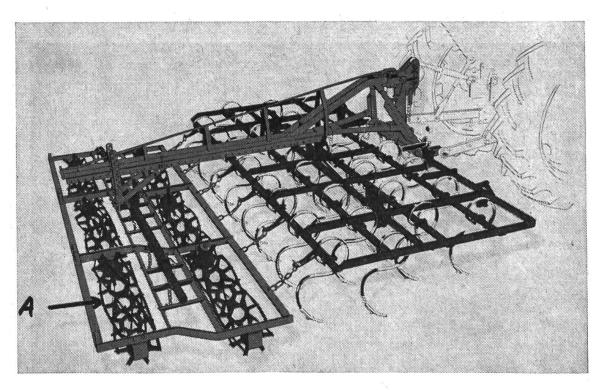
Fig. 5: Afin d'éviter la forte usure à laquelle l'émotteuse accouplée au vibroculteur se trouve soumise sur certains sols, on a remplacé dernièrement les fils métalliques par des tringles en acier (A).
