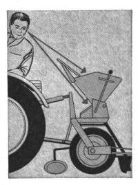
Fig. 9: Aspect du nouveau semoir en lignes Hassia, dont la trémie a été considérablement agrandie et conçue de telle façon que le déroulement du travail (quantité de graines restant dans la trémie et écoulement correct des graines) puisse être contrôlé du siège du tracteur.
