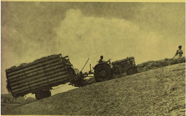
Le nouveau tracteur «Hürlimann» D-100 Super-spécial remorquant une chargeuse à foin «Agrar» sur un terrain en pente de 42 %.
