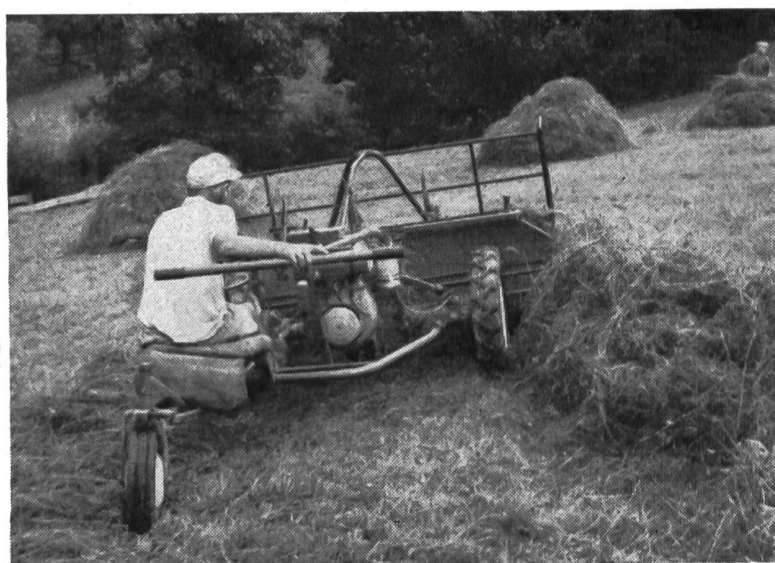
Fig. 2: Motofaucheuse équipée d'un faneur rapide (à roulettes commandées par barre de direction) qui met le foin en andains. En vue d'alléger le travail, cette motofaucheuse a été pourvue d'un siège monté sur roulette porteuse.
