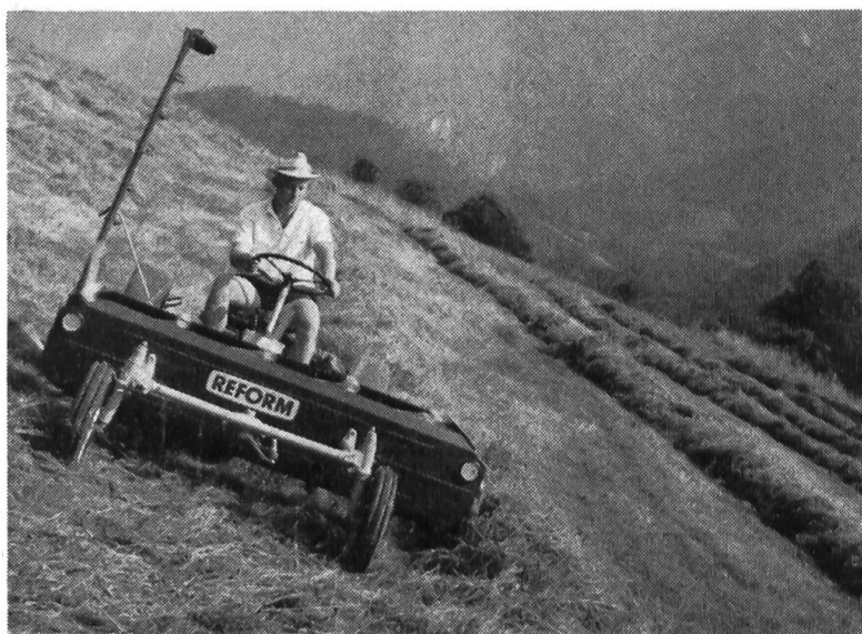
Fig. 8: Vue de la même machine mettant le foin en an- dains sur un champ en pente (on distingue la barre de coupe relevée.)
