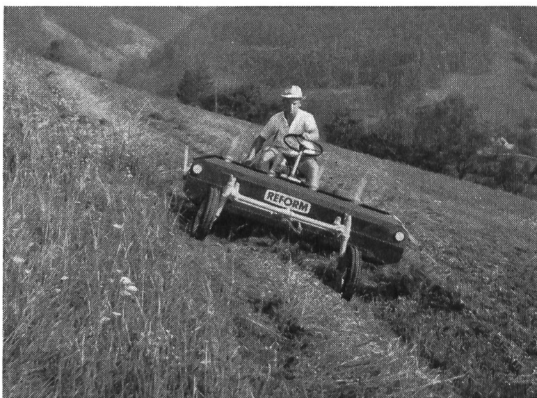
Fig. 7: La faucheuse-faneuse combinée automotrice effectuant simultanément la coupe et l'épandage du fourrage.
