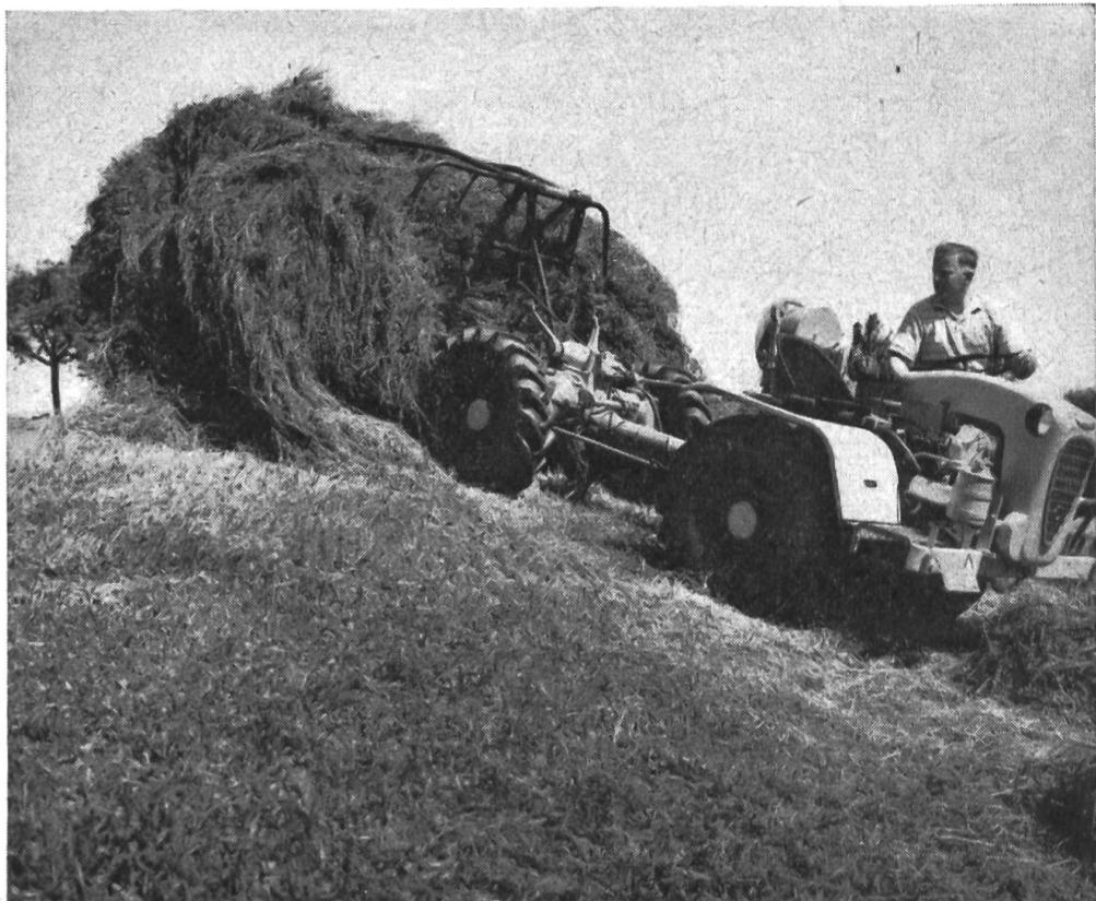
La ramasseuse-pinces adaptée au Pullax représente la solution idéale (pour le ramassage et le transport des fourrages), grâce à la surcharge de l'essieu avant. Tous les matériels prévus pour relevages hydrauliques à attelage trois-points normalisé (charrues, faneurs rapides, etc.) peuvent être utilisés avec le Pullax.
