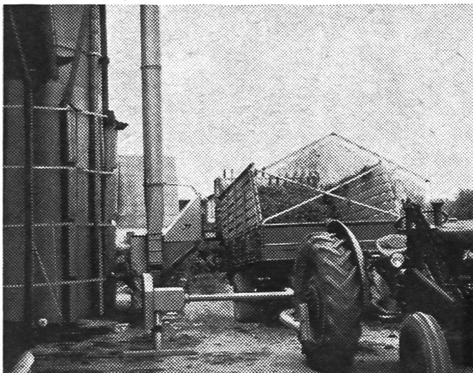
La SOUFFLEUSE D'ENSILAGE -JF- (actionnée par la prise de force du tracteur) et la remorque universelle -JF- (en tant que remorque-hacheuse) avec déchargeur combiné et déchargeur latéral, pendant l'opération d'ensilage.
