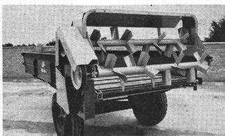
La REMORQUE UNIVERSELLE -JF- de 5 tonnes équipée du nouvel épandeur de fumier double.
