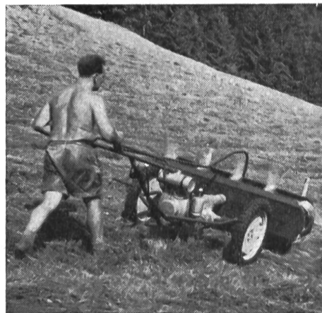
Fig. 6 et 7: Faneuse-andaineuse automotrice à chaînes porte-râteaux qui a été pourvue d'un système de guidage consistant en une longue barre de direction agissant sur les roulettes porteuses de la machine de travail.
