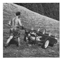
Fig. 6 et 7: Faneuse-andaineuse automotrice à chaînes porte-râteaux qui a été pourvue d'un système de guidage consistant en une longue barre de direction agissant sur les roulettes porteuses de la machine de travail.
