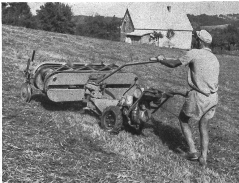
Fig. 3: Aspect d'une faneuse-andaineuse à chaînes porte-râteaux, dite faneur rapide, prévue pour les motofaucheuses. On l'adapte à l'avant de cette dernière après avoir enlevé la barre de coupe.
