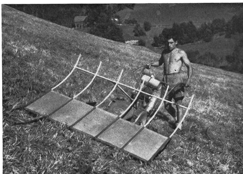
Fig. 1: Aspect d'une andaineuse frontale (réalisation autrichienne) spécialement prévue pour les motofaucheuses d'une puissance minimale de 5 ch. Sa largeur de travail est de 1 m 75.
