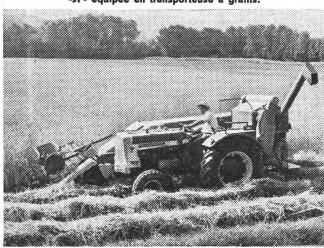
La longueur exceptionnelle du secoueur assure un nettoyage impeccable, notamment dans les terrains en pente.
