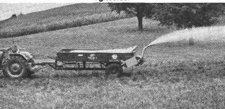
La REMORQUE UNIVERSELLE -JF- équipée en réservoir avec pompe d'aspiration et de refoulement, pendant l'opération d'épandage de purin (largeur d'épandage 12 m). La pompe centrifuge et de remplissage est actionnée par la prise de force.
